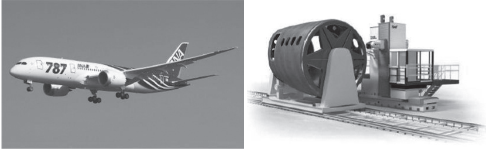
[그림 1-20] 복합재료 가공을 위한 극저온 가공시스템
