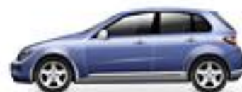
해치백 (Hatch-back) ▶ 트렁크와 뒷 유리가 함께 열림
